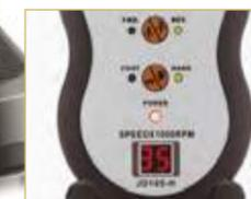
Il pannello comandi digitale permette la gestione della velocità, del controllo e della direzione di marcia, grazie al quale è possibile gestire un efficiente sistema di sicurezza contro il sovraccarico del manipolo.
